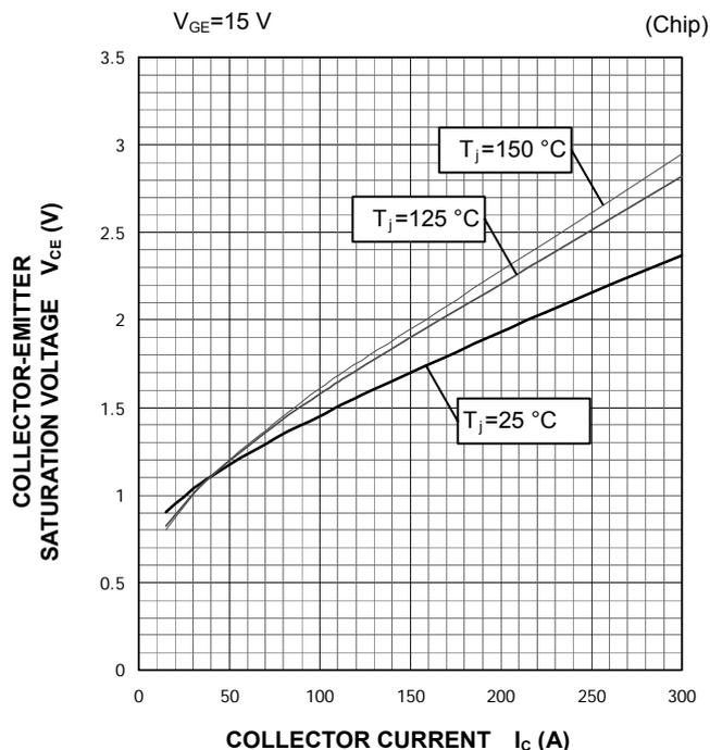
COLLECTOR-EMITTER SATURATION VOLTAGE
